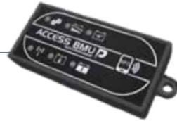
Die ACCESS BMU, **Battery - Monitoring - Unit** wird normalerweise während der gesamten Lebenszeit auf der Batterie montiert. Es misst Spannung, Strom, die Spannungsunterschiede innerhalb der Zellen, Temperatur und den Elektrolytstand der Batterien. ACCESS BMU kommuniziert mit allen anderen Access-kompartiblen Geräten per Funk. Beispielsweise kann es einem anderen Ladegerät mitteilen, welche Ladeparameter zum Einsatz kommen.
