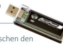
Das Access Service Tool ist Ihre Verbindung zwischen den Access-Geräten und Ihrem Laptop. Über Funk verbunden, lädt das Access Service Tool Daten von BMUs, BLUs und Ladegeräten herunter. Es generiert relevante Einzel- oder Flottenberichte. Führen Sie Upgrads aus und laden Sie alle Informationen über unsere GET Cloud hoch und verbinden Sie sich zu jeder Zeit per Handy oder Computer.
